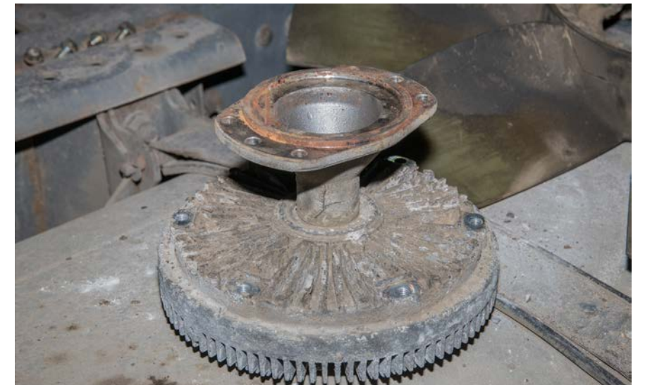
Муфта вентилятора также пострадала в огне. Ее покупка на разборке обошлась в 8 тыс. рублей
