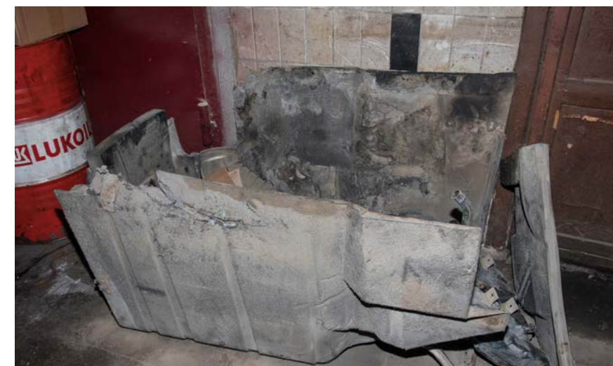
Тушить возгорание мешала тепло-шумовая защита, выполненная в виде короба. Так как оперативно демонтировать ее не представлялось возможным, ею пришлось пожертвовать
