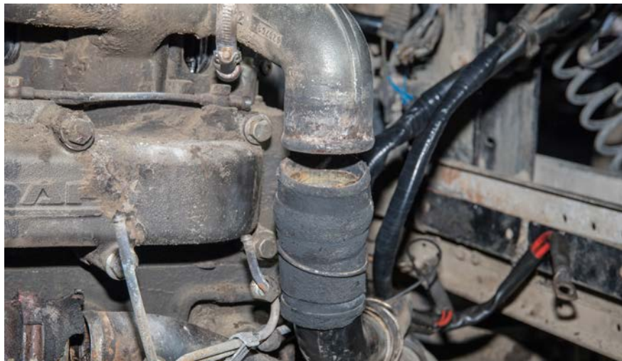
Соединительные манжеты – универсальные элементы. Подобрать их из наличия, ориентируясь по длине и диаметру оригинальной детали, несложно
