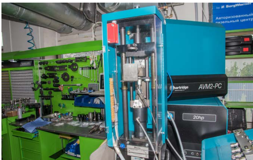
Для диагностики, снятия параметров агрегатов топливных систем Delphi, а также присвоения кодов форсункам необходимо оригинальное дилерское оборудование – стенд Hartridge AVM2-PC. Его имеют ограниченное число мастерских, выполняющих ремонт агрегатов систем питания дизельных двигателей
