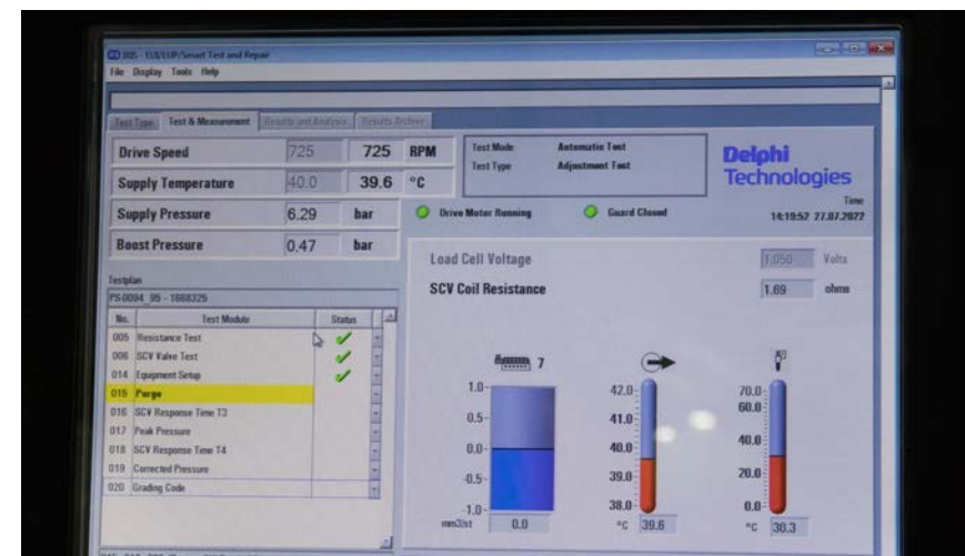
Функционал стенда позволяет проводить все поверочно-диагностические операции, а также контролировать работу агрегатов на всех режимах в реальном времени. Стенды альтернативных производителей, которые используют многие независимые мастерские, не могут отображать необходимый перечень параметров для их контроля. Это приводит к тому, что перебранные по обходным технологиям форсунки имеют существенные отклонения и изначально проигрывают по ключевым характеристикам (в том числе надежности и ресурсу) агрегатам, отремонтированным по оригинальной технологии и проверенным на оригинальном оборудовании
