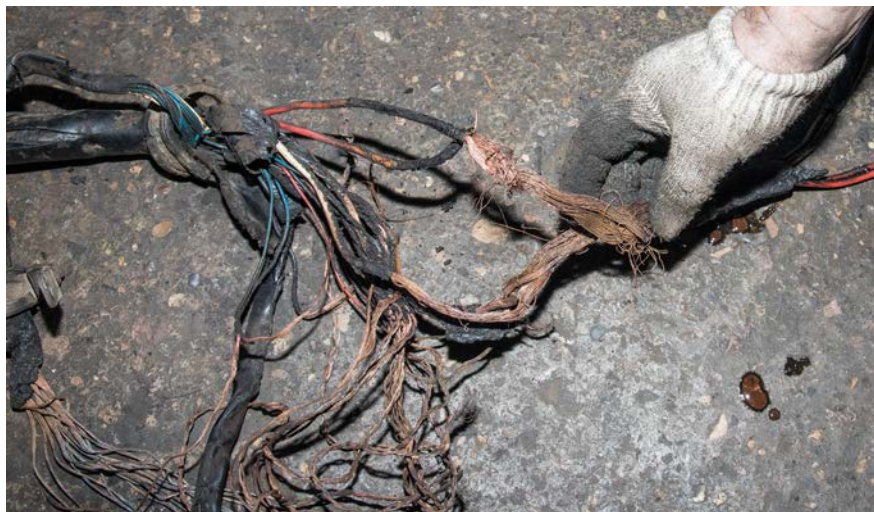
Виновник возникновения короткого замыкания и пожара – жгут проводов с перетертой изоляцией
