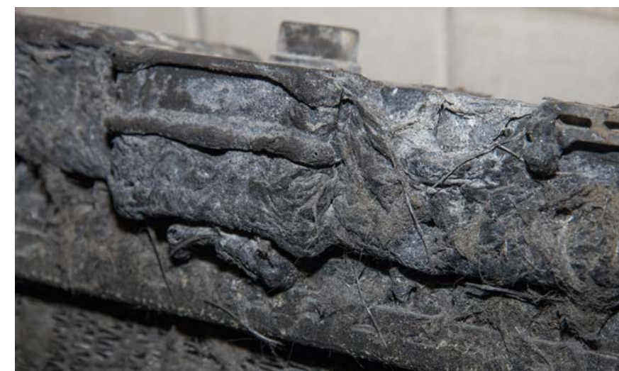
Оплавленные пластиковые бачки радиатора автоматически приговаривают его к списанию в утиль, даже если узел не потерял герметичность
