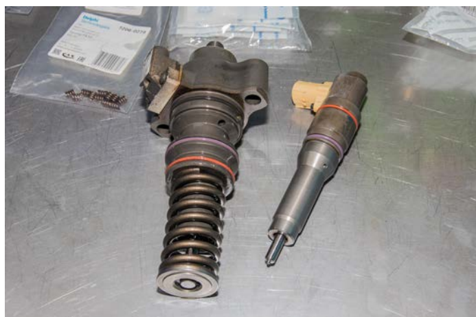
«Смарт»-секция состоит из управляемых электроникой индивидуальной насосной секции и инжектора, которые соединены между собой короткой трубкой
