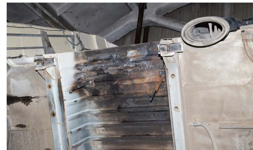
Пол в кабине обгорел. Для предотвращения его коррозионного разрушения потребовалось восстановление лакокрасочного покрытия
