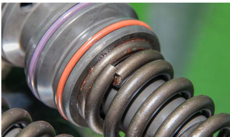
Разрушение пружины спровоцировали ударные нагрузки. О том, что трещина развивалась длительное время, говорит коррозия на месте излома
