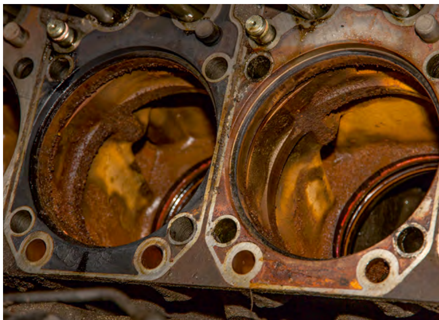
Коррозия внутри рубашки охлаждения блока цилиндров сокращает ресурс свежего антифриза
