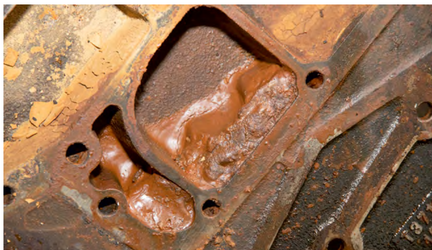
Использование антифриза низкого качества может привести к сильной коррозии блока цилиндров и образованию большого количества отложений в системе охлаждения
