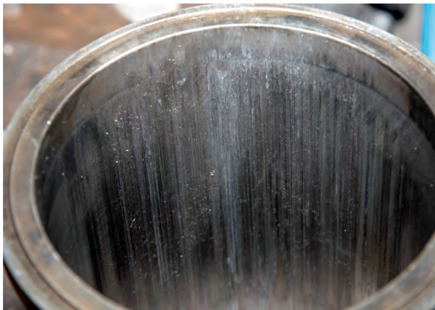
Из-за некачественного антифриза возникает нарушение теплового режима двигателя, как следствие – перегрев и задиры в цилиндрах
