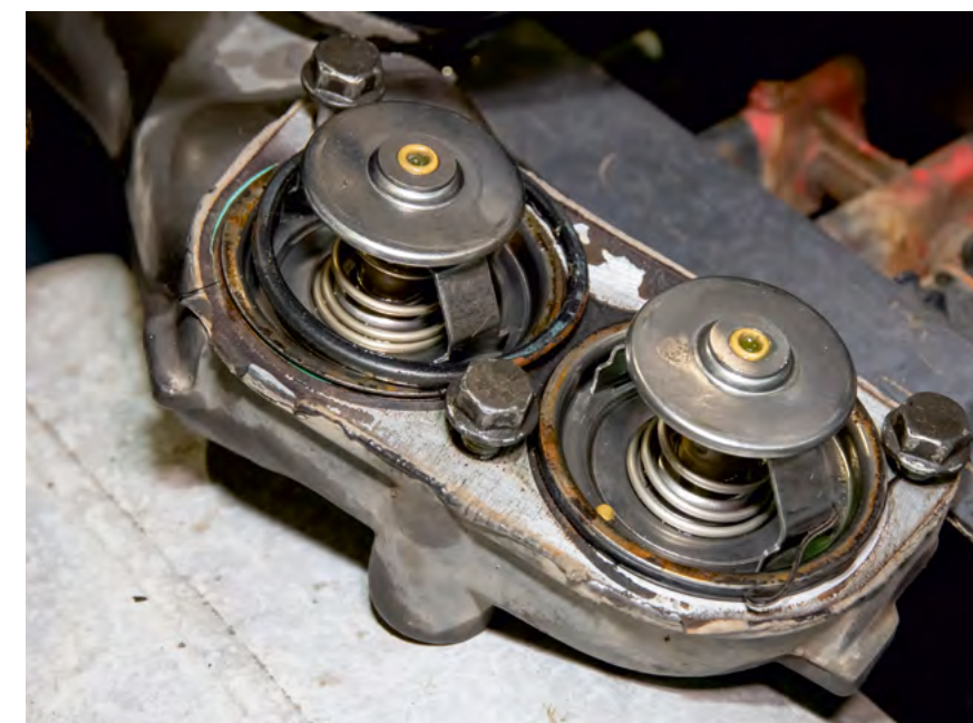
Некачественный антифриз может вывести из строя термостаты, что приведет к нарушению теплового режима работы двигателя
