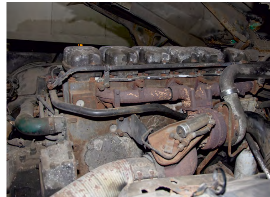
Моторы с большим пробегом, как правило, имеют загрязнения контура охлаждения. Для них интервал замены охлаждающей жидкости рекомендуется сократить на 25 %
