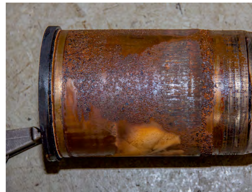
Гильза цилиндра со следами кавитационного разрушения. Пакет присадок антифриза не имел противокавитационных компонентов
