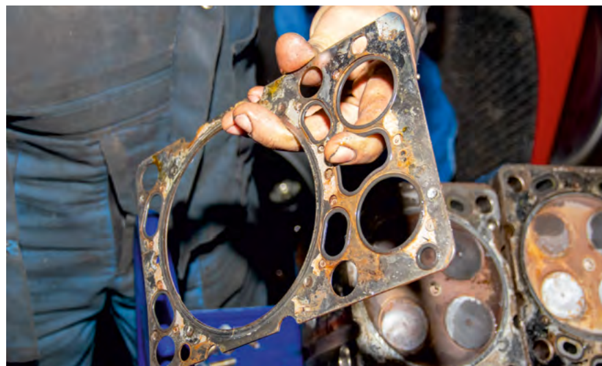
Из-за некачественного антифриза происходит разрушение прокладки головки блока цилиндров и попадание охлаждающей жидкости в цилиндры, а также в систему смазки
