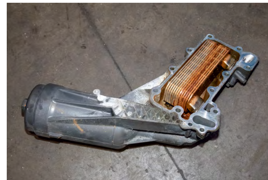
Теплообменник со следами коррозии – признак использования некачественного антифриза
